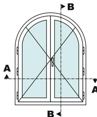
**NOTA :** Le profil d'ouvrant à la française utilisé pour les châssis à un vantail cintrés est identique. Les menuiseries ouvrant à la française cintrée ou linteau droit de la gamme AWS60 sont sur demande uniquement. ■
